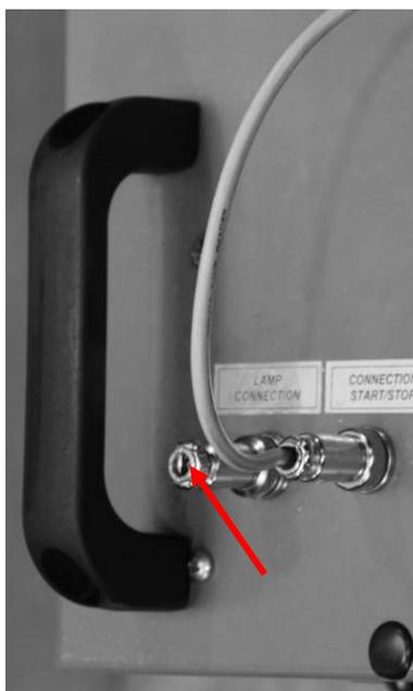
Brancher le câble (livré avec le bras), dans la prise « LAMP CONNECTION » en X1&X2 (selon le schéma page 21)
