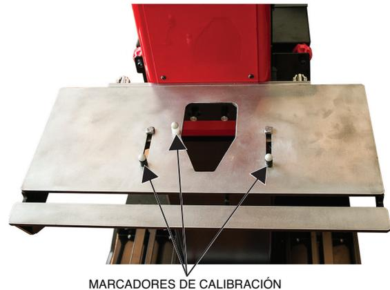
7. Con los marcadores LED en su lugar, seleccione el icono de 'Start Calibration' (Iniciar Calibración) en la pantalla. Los marcadores LED en la pantalla iniciarán a parpadear mientras aparecen varios números sobre ellos. Durante este momento, el equipo está determinando la posición de la plataforma de fijación. Vea la Figura B.40.
