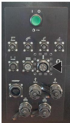
**CONEXIÓN DEL COLGANTE DE AJUSTE DE ALTURA**
