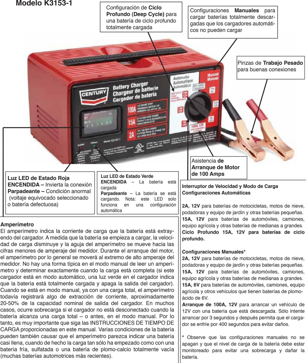
**Luz LED de Estado Roja ENCENDIDA** – Invierta la conexión **Parpadeante** – Condición anormal (voltaje equivocado seleccionado o batería defectuosa)
