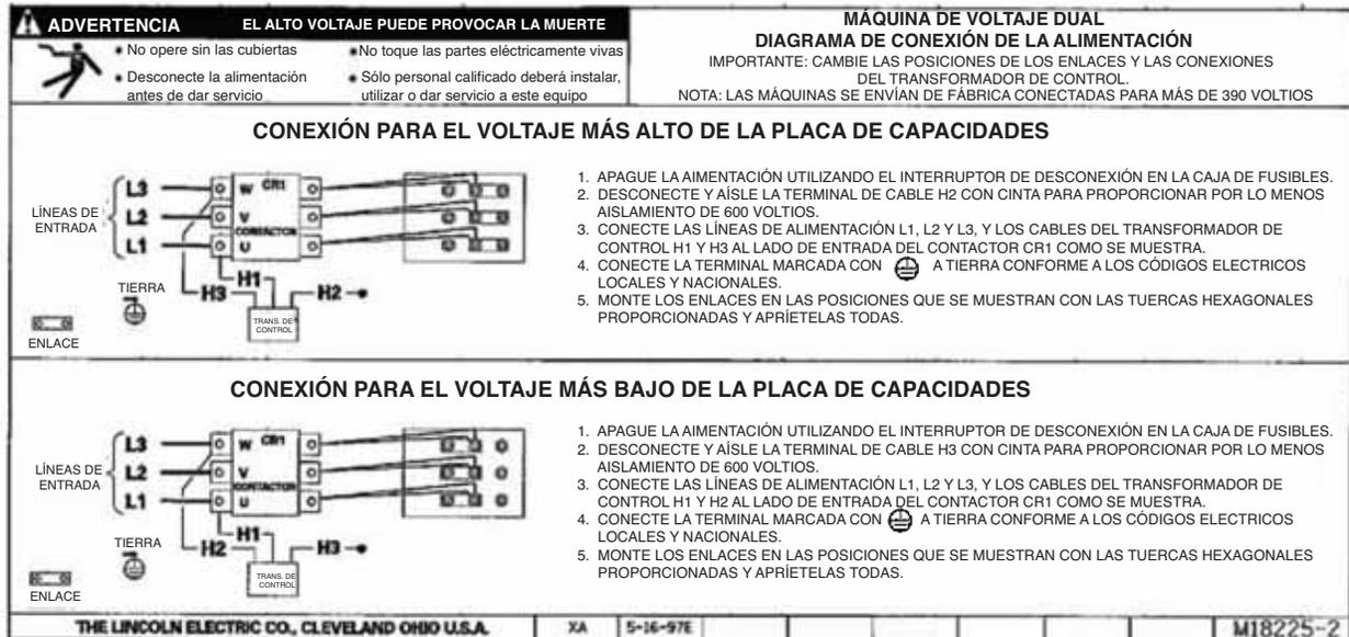
FIGURA A.2 Procedimiento de reconexión de la Máquina de Voltaje Dual
