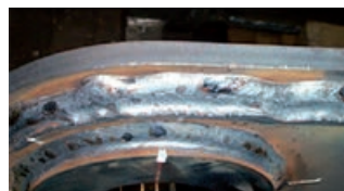
Efekt złego prowadzenia drutu
