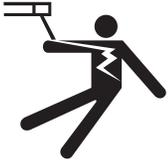
• LES CHOCS ÉLECTRIQUES PEUVENT ÊTRE MORTELS. A moins d'utiliser la fonctionnalité d'ALIMENTATION À FROID, lorsqu'on soude avec la gâchette du pistolet, l'électrode et le mécanisme d'entraînement se trouvent toujours sous énergie électrique et ils peuvent le rester pendant plusieurs secondes après que le soudage ait cessé.
