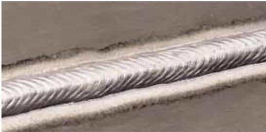
La fréquence des impulsions est ajustable. Le changement de la modulation de fréquence (ou du contrôle d'arc) de la forme d'onde modifie l'espacement des vagues de solidification. On peut obtenir des vitesses de déplacement plus rapides en utilisant des valeurs de modulation de fréquence supérieures.
