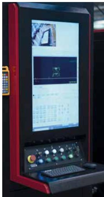
È dotata di un ampio schermo di controllo che integra la visualizzazione di 2 telecamere di monitoraggio. Controlla tutte le operazioni della macchina. Include un software di disegno e nesting automatico e un database di parametri per tutti gli spessori su acciaio al carbonio, acciaio inox e materiali in alluminio.
