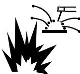
Las **CHISPAS DE SOLDADURA** pueden provocar un incendio o explosión
