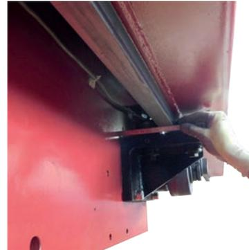
Die Waagrechtigkeit des Arms kontrollieren. Dazu eine Wasserwaage auf die Armschiene legen.
