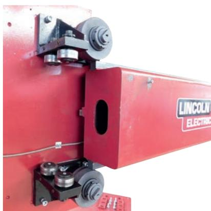
Den mechanischen Anschlag mit 2 M10 X 40 CHC Schrauben fixieren. Die 2 elektrischen Endanschläge mit 2 M 5 X 30 CHC Schrauben fixieren.
