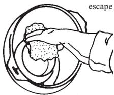
escape podrá dar un sello eficiente y provocar una fuga. Asegure que todos los contaminantes hayan sido eliminados antes de insertar el filtro nuevo.
