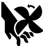
1.g. Para impedir el arranque accidental de los motores de gasolina mientras se hace girar el motor o generador de la soldadura durante el trabajo de mantenimiento, desconectar los cables de las bujías, tapa del distribuidor o cable del magneto, según corresponda.
