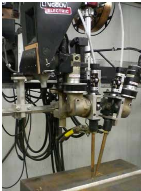
Rysunek 5-2: Konfiguracja systemu tandem z dwiema elektrodami DC-AC
