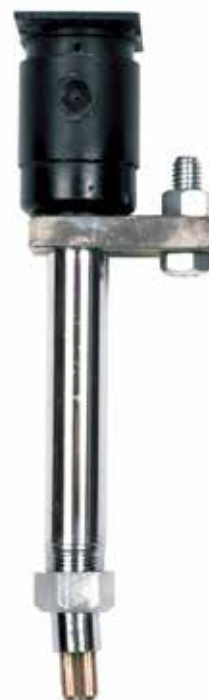
Rysunek 6-9: Dysza kontaktowa Lincoln Electric Tiny Twinarc może podawać dwie elektrody do szybkiego wykonywania spoin łukiem krytym w płytach od 14 ga (1,89 mm) i grubszych.
