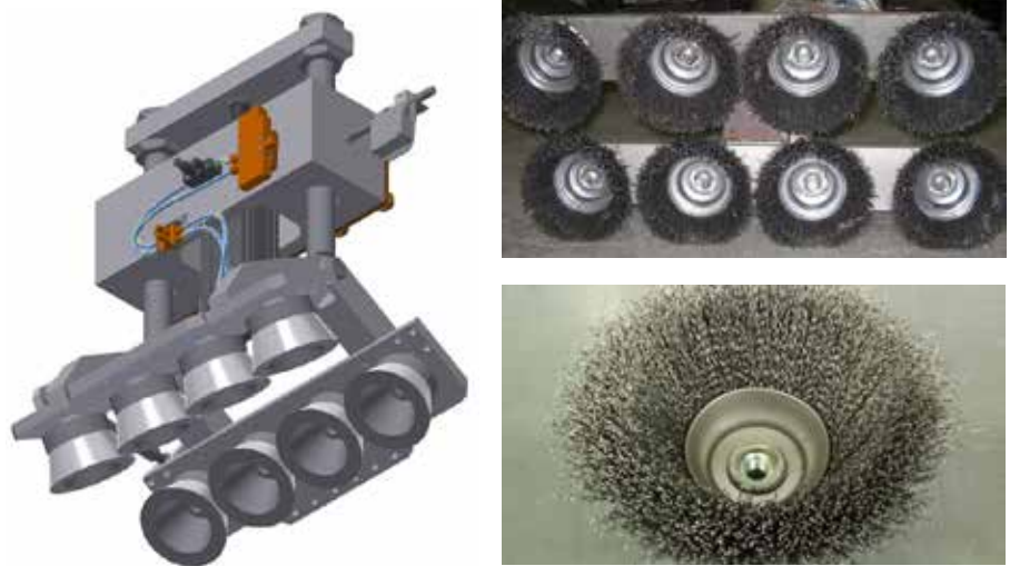
Rysunek 4-9: Szczotki uziemiające przymocowane do wspornika.
