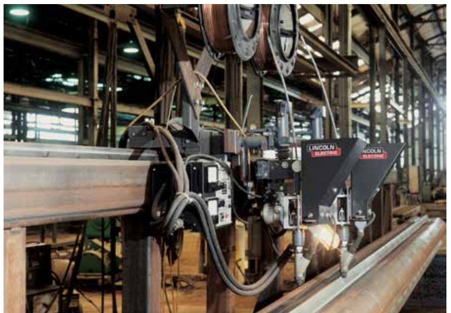
Stanowisko do spawania łukiem krytym
