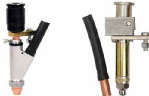
Rysunek 4-4: Przedstawia metody podawania topnika; Z lewej zespół dyszy kontaktowej Lincoln Electric, który podaje topnik wokół elektrody; Z prawej strony zespół dyszy kontaktowej Lincoln Electric, który podaje topnik przed łukiem;
