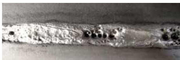
Rysunek 7-6: Porowatość spowodowana zabrudzeniem olejem.
