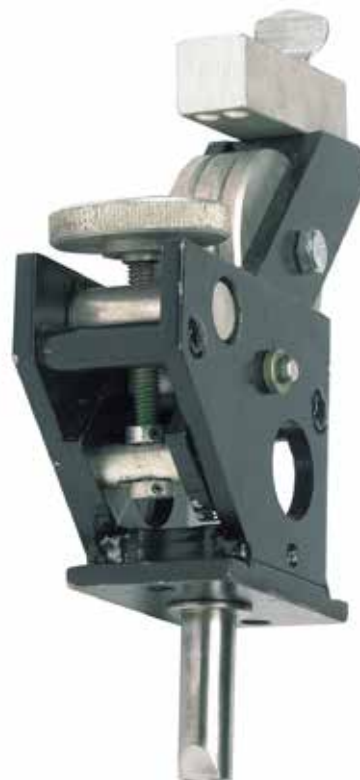
Rysunek 6-10: Układ prostowania drutu Lincoln Electric Tiny Twinarc przeznaczony jest do drutów o średnicy 0,045–3/32 cala (1,2 do 2,4 mm). Jest szczególnie przydatny w procedurach z większą odległością CTWD.
