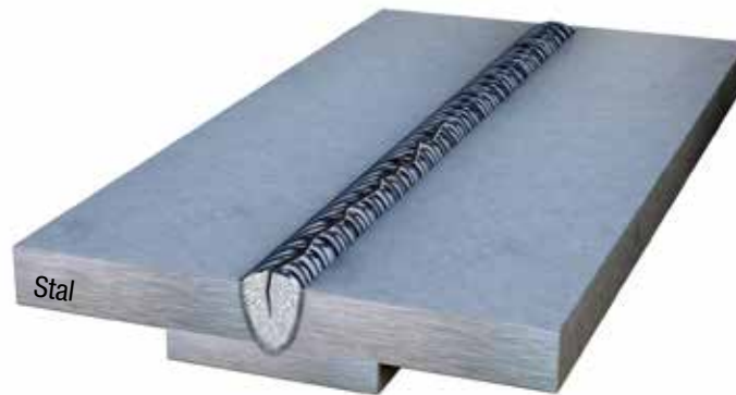
Rysunek 7-10: Pęknięcia wzdłużne
