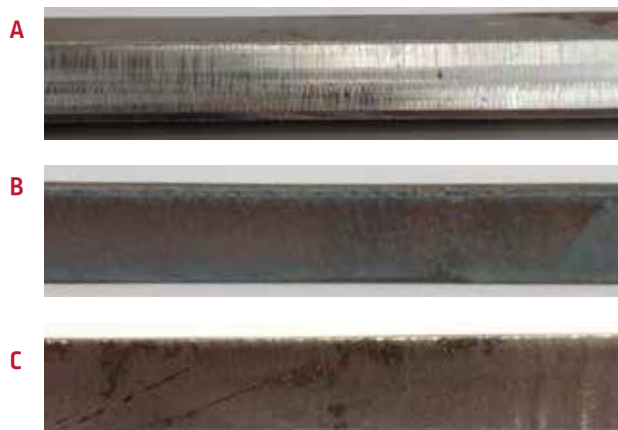
Rysunek 7-4: Dobre, wolne od porowatości spoiny można wykonywać na materiałach obrabianych mechanicznie i ciętych gazowo oraz na nieobrabianych z niedużą zgorzeliną walcowniczą. Zob.: A, materiał obrabiany mechanicznie; B, materiał cięty gazowo; C, materiał bez obróbki.
