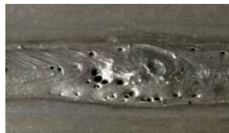
Rysunek 7-7: Pęcherze gazowe w spoinie wynikające z niedostatecznego pokrycia topnikiem
