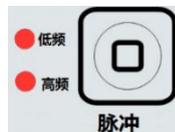
在 模式下, 按压脉冲按钮, 打开脉冲功能。当脉冲功能激活时, 相应指示灯点亮, 低频模式频率范围为: 0.2Hz~20Hz, 高频模式频率范围为: 10 Hz ~300 Hz。在 模式下该功能将被禁止。
