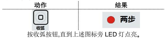
氩弧焊 2 步模式焊接时序:
