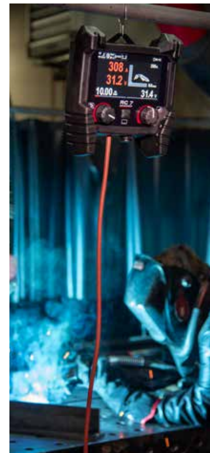
Support (anneau de levage) pour suspendre la RC-7 pour un usage en hauteur.
