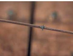
Una vez que se han soldado los extremos del hilo y se ha eliminado la rebaba, se debe fijar el hilo entre los 2 bidones utilizando el puente situado en el centro de la estructura. Para ello, empuje los pernos con muelle en ambos lados. Cuando esté bien ajustado, el brazo de transferencia debe oscilar de un bidón a otro.
