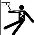
1.a. Los circuitos del electrodo y de masa están eléctricamente con tensión cuando el equipo de soldadura está encendido. No tocar esas piezas con tensión con la piel desnuda o con ropa mojada. Usar guantes secos sin agujeros para aislar las manos.
