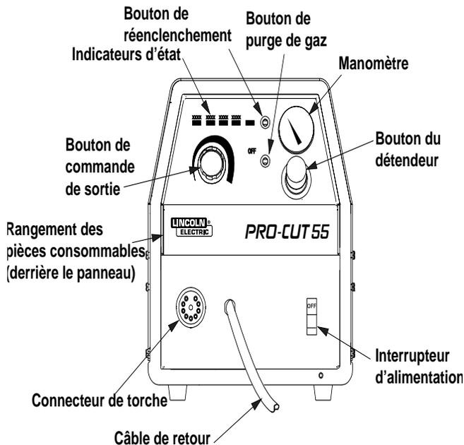
Quand on se prépare à couper ou à gouger, placer la machine le plus près possible de la pièce. S'assurer de disposer de tous les matériaux nécessaires pour effectuer le travail et d'avoir pris les mesures de sécurité. Il est important de suivre ces étapes de fonctionnement chaque fois que l'on utilise la machine.
