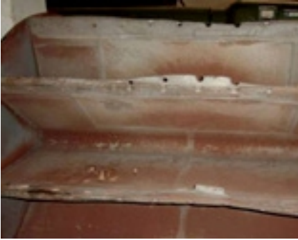
Koruma İşlemi Uygulanmamış Tambur — 6 Ay Çalıştıktan Sonra —
