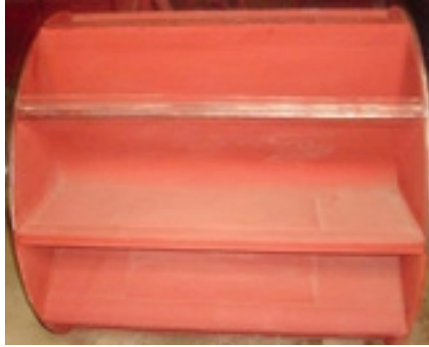
Weartech® ile Korunmuş Tambur — Montaj Aşaması —
