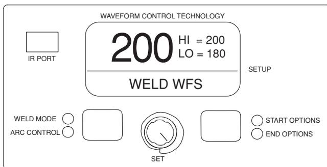
El ejemplo anterior muestra un modo de alambre; los modos de soldadura de corriente constante mostrarían "Amps de Soldadura" ("Weld Amps") en lugar de "WFS de Soldadura" ("Weld WFS").
