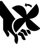
7.d. Mantener todos los protectores, cubiertas y dispositivos de seguridad del equipo en su lugar y en buenas condiciones. No acercar las manos, cabello, ropa y herramientas a las correas en V, engranajes, ventiladores y todas las demás piezas móviles durante el arranque, funcionamiento o reparación del equipo.
