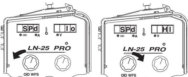
Posteriormente, rotar la perilla a la posición de las 12. Presionar el botón de ajuste.
