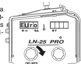
Presionar el botón de ajuste para acceder al menú de calibración WFS.
