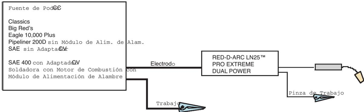
Si la fuente de poder tiene un interruptor Remoto/Local, coloque éste en la posición Local.
