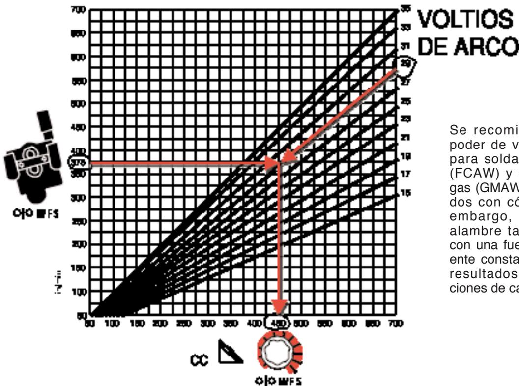
Se recomienda una fuente de poder de voltaje constante (VC) para soldadura de arco tubular (FCAW) y de arco metálico con gas (GMAW) para obtener resultados con código de calidad. Sin embargo, este alimentador de alambre también puede usarse con una fuente de poder de corriente constante (CC) para obtener resultados pasables en aplicaciones de calidad no críticas.
