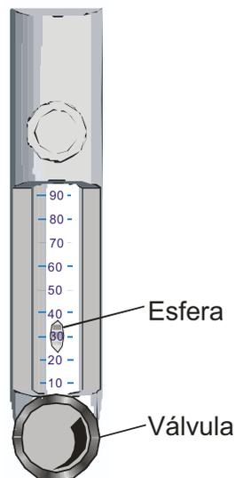
Para obtener velocidad de flujo máxima, utilizar un regulador con compensación de presión de 30 psi o mayor.
