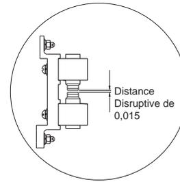
**Note** : dans des environnements extrêmement sales, des contaminants conducteurs sont présents en abondance ; utiliser de l'air à pression faible ou un morceau de papier ferme pour nettoyer l'éclateur. Ne pas toucher au réglage de la distance disruptive effectué à l'usine.
