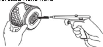
Elemento filtro aria in espanso: pulire in acqua saponata tiepida, sciacquare e lasciare asciugare accuratamente. Oppure pulire in solvente non infiammabile e lasciare asciugare.
