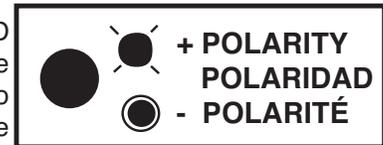
para polaridad positiva. Utilice el LED de polaridad para verificar que el alimentador de alambre esté conectado para la polaridad correcta.
