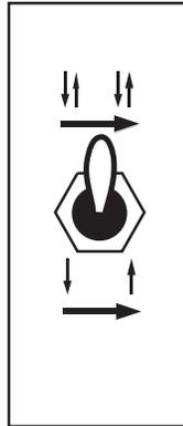
Coloque el interruptor de palanca en la posición hacia ABAJO para la operación de 2 Pasos o en la posición hacia ARRIBA para la operación de Interbloqueo del Gatillo.
