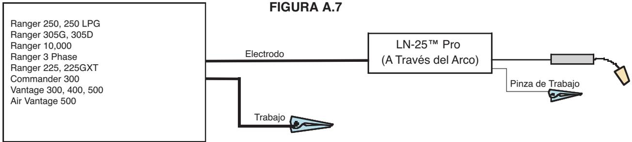
Coloque el interruptor CV/CC en el alimentador en la posición “CV”.
