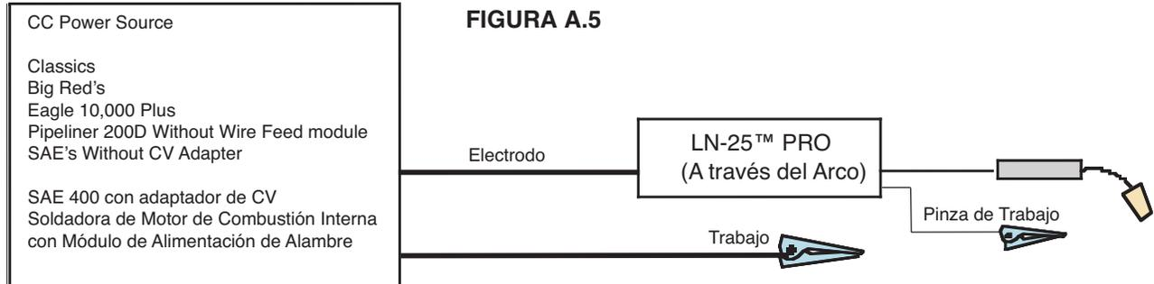
Si la fuente de poder tiene un interruptor Remoto/Local, coloque el interruptor en la posición Local.
