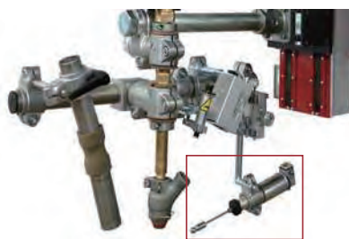
带有传感探针的焊缝跟踪
