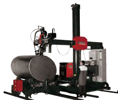
用十字臂设备焊接椭圆罐体的环焊缝
