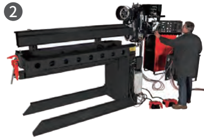
EX: 外部焊接
