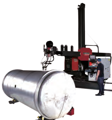
用十字臂设备和变位机焊接环焊缝
