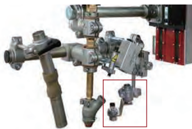
带有电感探针的焊缝跟踪
