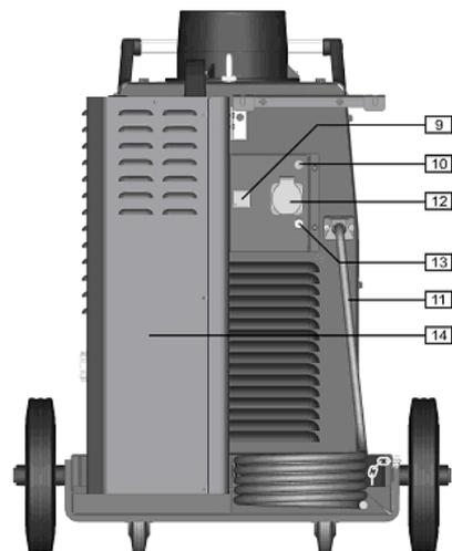
9. Abgedeckter Gehäuseausschnitt: Ermöglicht den Einbau einer Steckdose für ein CO<sub>2</sub>-Heizgerät (siehe Zubehör K14009-1, CO<sub>2</sub>-Anschluss).
