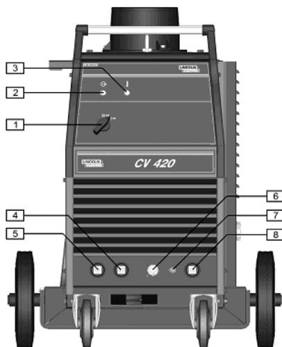
1. Netzschalter EIN/AUS (O/I): Er schaltet die Stromversorgung der Maschine. Vergewissern Sie sich, dass die Maschine an das Stromnetz angeschlossen ist, bevor Sie diese einschalten ("I").
