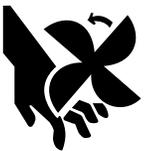
1.f. Ne pas mettre les mains près du ventilateur du moteur. Ne pas appuyer sur la tige de commande des gaz pendant que le moteur tourne.
