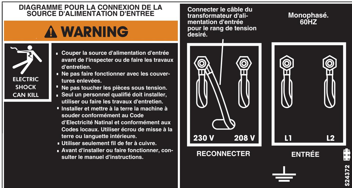
3. Le modèle POWER MIG 208/230 V 60 Hz est expédié avec un câble d'entrée de 10 pi et fiche connecté à la machine. Une prise correspondante est fournie avec la machine. Monter la prise à un endroit convenable en utilisant les vis fournies. S'assurer qu'elle n'est pas trop éloignée pour qu'on puisse y connecter la fiche du câble d'entrée raccordé à la machine. Raccorder, la mise à la terre sur le haut pour permettre au câble d'alimentation de pendre sans plier.
