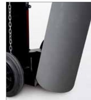
La entrada baja del cilindro de gas facilita su carga
