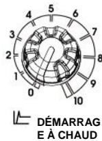
**Cadran de commande de force d'arc**
