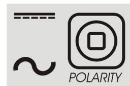
Questa icona è progettata per impostare la polarità del processo corrente: DC+, AC con elettrodo manuale, DC- e AC TIG.
