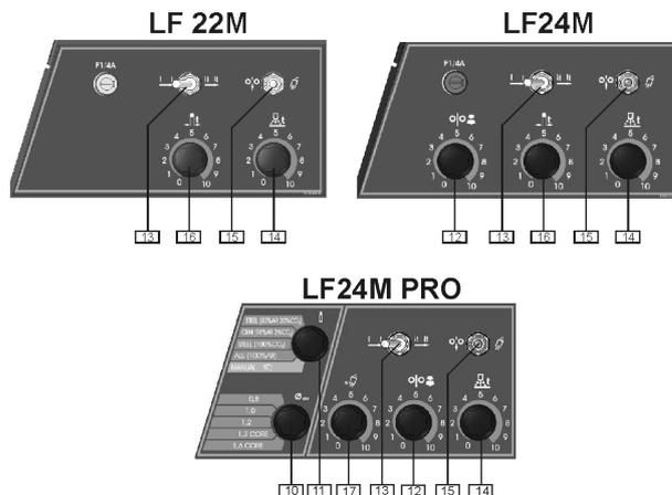
10. **Manopola Diametro Filo:** Permette la scelta del diametro filo richiesto per il procedimento desiderato. Funziona soltanto nel modo sinergico.
