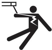
• **CHOQUE ELÉTRICO PODE MATAR.** A menos que esteja usando a característica de **ALIMENTAÇÃO FRIA**, o eletrodo e o mecanismo de tracionamento estão sempre energizados e podem permanecer energizados durante vários segundos após o término da soldagem.
