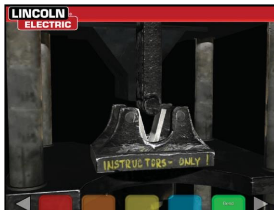
Figura 102 – Test di curvatura completato
