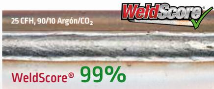
Cordón de soldadura aceptable: Un caudal de gas de protección adecuados producen una buena soldadura sin poros.
