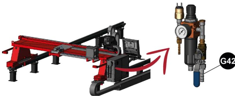
Den Druckluftschlauch auf dem seitlich vom Schaltschrank Pkt. **G42** befindlichen Filter anschließen.
