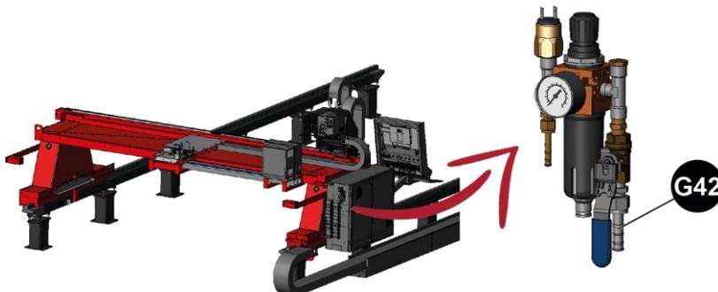
Conectar el tubo de aire comprimido con el filtro situado en el lado de la caja eléctrica en **G42**.
