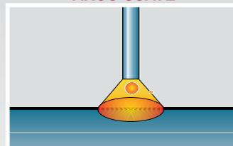
Al soldar en modo suave, la Fuerza de Arco autoadaptable se mantiene a un nivel bajo, proporcionando la suavidad de arco ideal para electrodos de rutilo e inoxidable.
