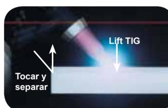
En el modo TIG el equipo tiene un circuito de voltaje bajo para reducir la contaminación de tungsteno. Tocar el tungsteno con la pieza a soldar y levantar. El equipo elevará la tensión y la corriente para establecer el arco sin utilizar la alta frecuencia.
