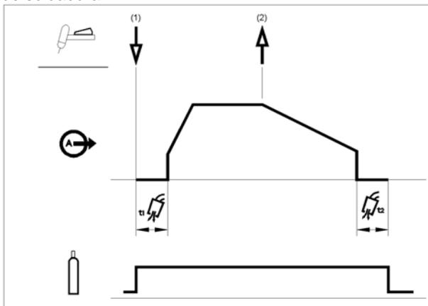
1. Prima e mantenha premido o gatilho do maçarico TIG para iniciar a sequência. A máquina abre a válvula de gás para iniciar o fluxo do gás de protecção. Decorrido o tempo de pré-fluxo, para purgar o ar do tubo do maçarico, a saída da máquina é LIGADA. Neste momento, o arco inicia-se de acordo com o modo de soldadura seleccionado. Uma vez iniciado o arco, a corrente de saída é aumentada a uma cadência controlada, ou tempo de subida, até se atingir a corrente de soldadura.
