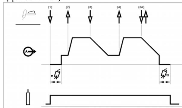
3. Prima e mantenha premido o gatilho do maçarico TIG. A máquina diminui a corrente de saída a uma cadência controlada, ou tempo de descida, até se atingir a corrente de Cratera.
