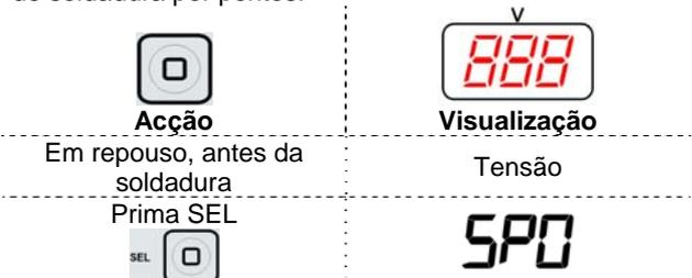
Neste ponto, o tempo do ciclo de soldadura por pontos pode ser ajustado rodando o botão da Corrente de saída. Definir o tempo do ciclo de soldadura por pontos para 0 desactiva a função de tempo fixo e o tempo de soldadura fica ligado ao gatilho do maçarico TIG.
