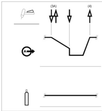
Como se mostra aqui, depois de mais uma vez se premir rapidamente e soltar o gatilho do maçarico TIG a partir do passo 3A, é possível premir rapidamente e soltar o gatilho do maçarico TIG uma segunda vez para terminar o tempo de descida e parar a soldadura.
