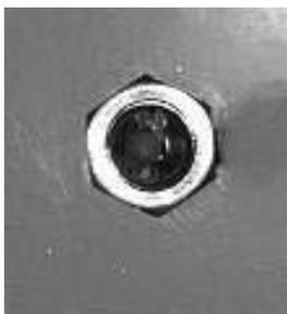
Ce bouton ne doit en aucun cas servir de bouton de mise en marche. Il ne doit être utilisé qu'en cas d'urgence.
