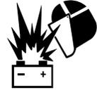
• **CONECTE UN CARGADOR DE BATERÍA** — retire la batería de la soldadora desconectando el cable negativo primero, y después el positivo y la abrazadera de la batería. Cuando reinstale, conecte al último el cable negativo. Mantenga una buena ventilación.
