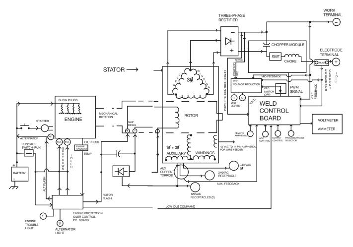
FIGURE E.1 - VANTAGE® 400 BLOCK LOGIC DIAGRAM.
