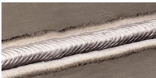
Frequência de pulsagem é ajustável. Mudando a modulação da frequência (ou UltimArc) da forma de onda muda o espaçamento de ondulações. Mais altas velocidades de deslocamento podem ser alcançadas, usando valores mais alto de modulação de frequência.
