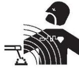
Das Gerät erzeugt elektrische und magnetische Felder, die bestimmte Arten von medizinischen Geräten, wie z. B. Herzschrittmacher, stören können. Jede Person, die einen Herzschrittmacher oder ähnliches verwendet, sollte vor der Bedienung, Beobachtung, Wartung oder Instandhaltung des Geräts einen Arzt konsultieren.
