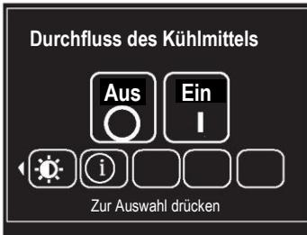
**KÜHLMITTELFLUSS** – Ermöglicht die manuelle Steuerung der Kühlmittelpumpe zum Ansaugen oder zur Fehlersuche.
