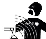
2.a. Le courant électrique qui circule dans les conducteurs crée des champs électromagnétiques locaux. Le courant de soudage crée des champs magnétiques autour des câbles et des machines de soudage.
