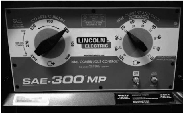
2. Placer le **Cadran de Gauche** (Courant Approximatif) sur le Courant Souhaité.
