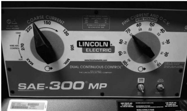
3. Pour un arc plus puissant, augmenter le courant approximatif et diminuer le courant précis. Pour un arc plus souple, augmenter le courant précis et diminuer le courant approximatif.
