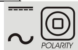
Cette icône sert au réglage de la polarité du procédé en cours d'utilisation : électrode enrobée CC+ et CA, TIG CC- et CA.
