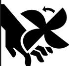
1.f. Ne pas mettre les mains près du ventilateur du moteur. Ne pas appuyer sur la tige de commande des gaz pendant que le moteur tourne.
