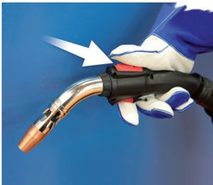
Variation du débit d'aspiration commandé par l'opérateur par appui sur le microswitch.
