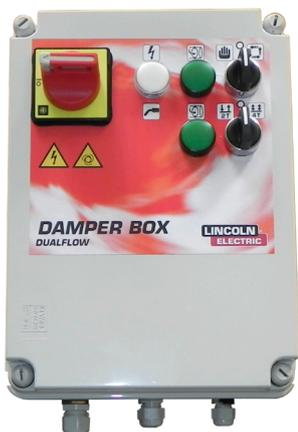
Coffret de commande **DAMPER BOX DUAL FLOW** assurant la gestion de deux registres pneumatiques Haute Dépression pour la modulation du débit d'aspiration à la torche.
