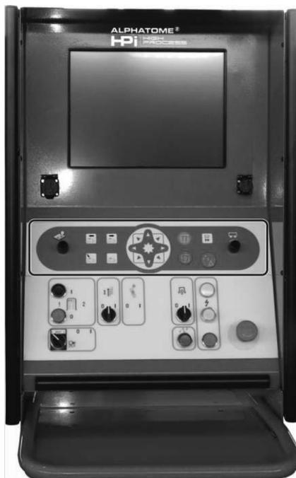
L' **HPC** permette di gestire automaticamente i parametri di taglio in funzione dell'installazione e del materiale da tagliare in associazione ai programmi pezzi.
