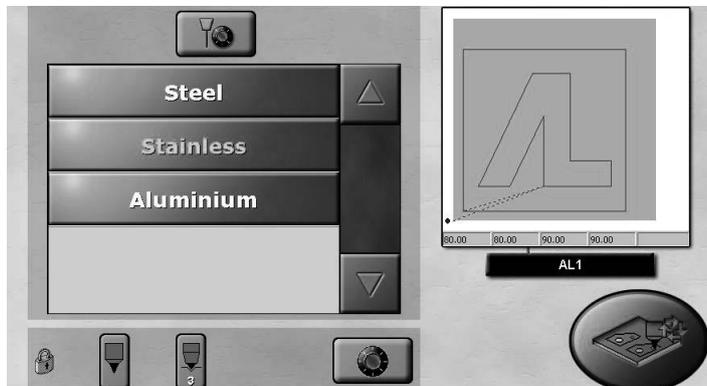
*Questa maschera permette di scegliere il materiale da tagliare con i processi interni o di selezionare un processo esterno.*
