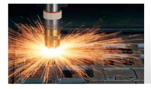
Durante le operazioni di taglio manuale o automatico, con cannello o al PLASMA, i fumi vengono generati sotto la lamiera tagliata e verranno quindi rilevati al di sotto del piano di lavoro.
