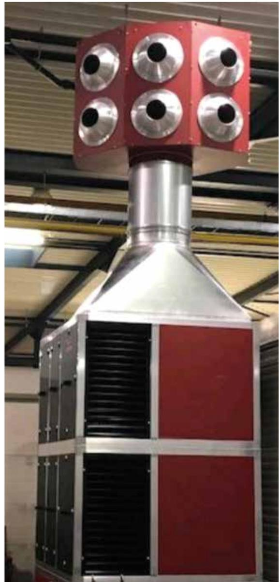
AMBICLEAN è dotato di cartucce filtranti con membrana PTFE ad altissima efficienza (99,97% per particelle di 0,15 µm). Tuttavia, i gas emessi nei fumi di saldatura non possono essere trattati in sicurezza da nessun dispositivo. Pertanto, si consiglia di associare un volume d'aria nuovo corrispondente al 20% del volume dell'aria trattato dall'impianto.
