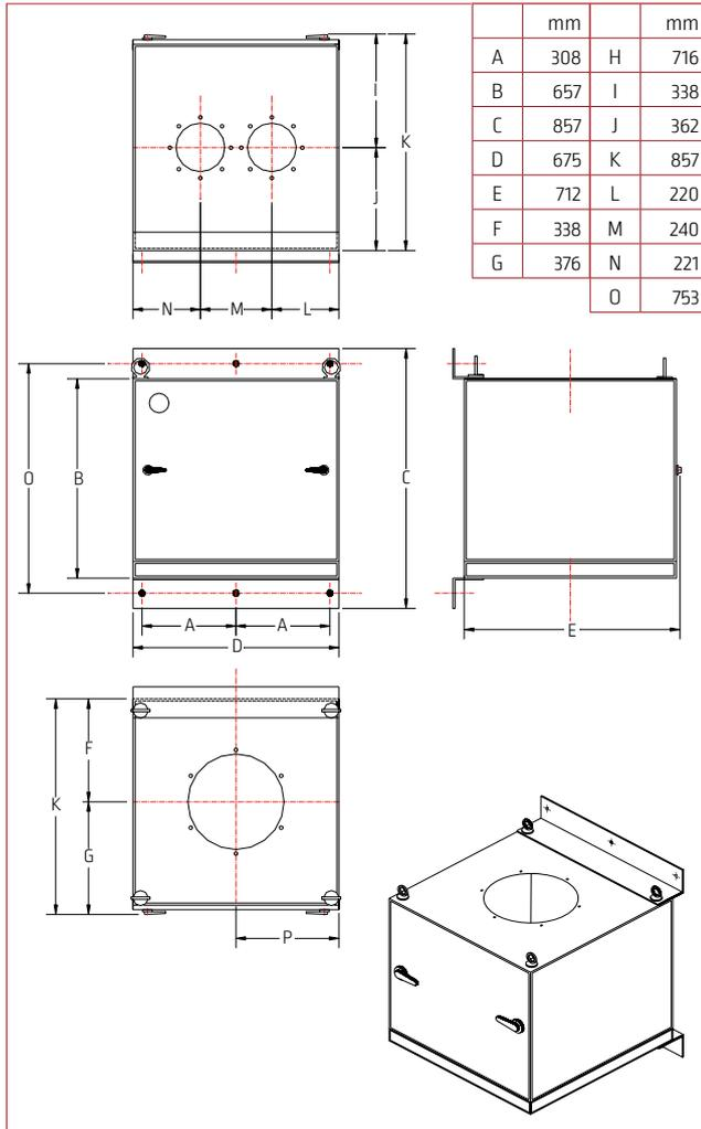
Piano di installazione MECAZUR 35M versione a terra
