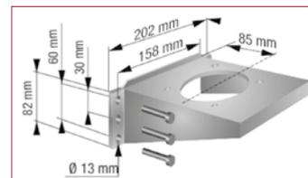
Fissaggio a muro di un braccio TELESCOPICO
